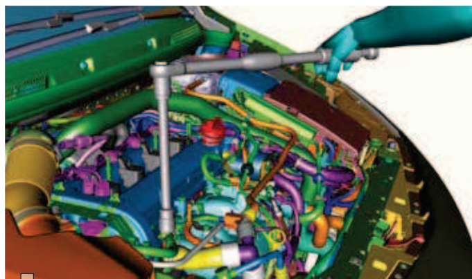
Virtuelle Aus- Einbauversuche werden mittels Konstruktionsdaten und Prototypen vorgenommen. Trial installations and removals are executed by means of design data and prototypes.
